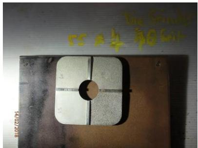
Figure 5- DH55 – Flapper disc #40
